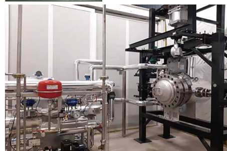
High Pressurized Water Test Rig 200°C 3.5 MPa 高温高圧水テストリグ
